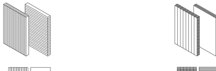
Abbildung 12: Vergleich zwischen Brettstapelbauweise (links) und Brettsperrholzbauweise (rechts) [2]
